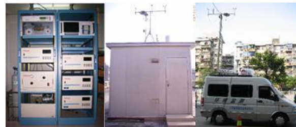
固定式和车载式交通环境空气质量自动监测站 监测数据 (环境类: PM_{2.5} 、机动车尾气等)
